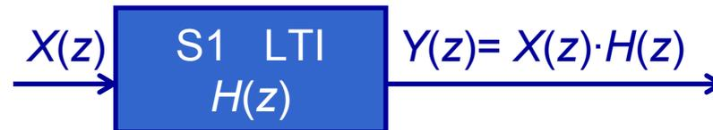
$H(z) \equiv$  **Función de sistema**  $\equiv$  **Función de transferencia**
