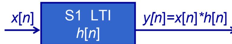
Si  $x[n]$ ,  $h[n]$  e  $y[n]$  tienen TZ, y aplicando la propiedad de convolución, obtenemos en el dominio transformado:
